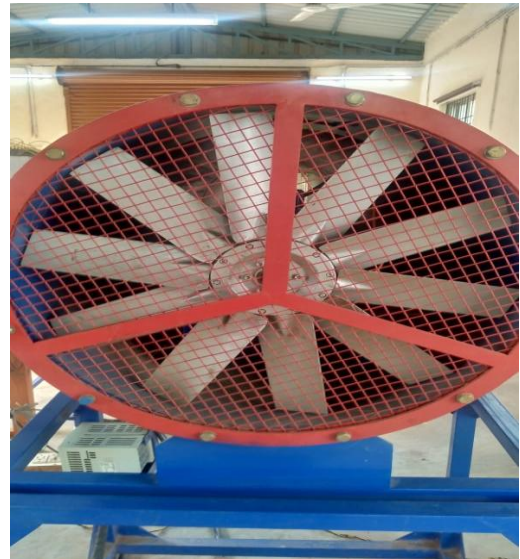
Fig. 3. Wind tunnel fan with 10 blades
